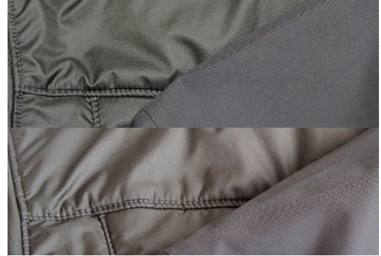
Aynı iki kumaş, ancak farklı ışık kaynakları altında. Soldaki yeşilden kahverengiyeye dönüşüyor.
